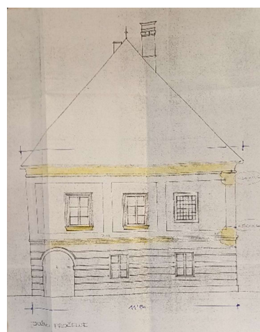
Sl. 35-38. Rekonstrukcija pročelja, izradio T. Premerl, 1975. godine - s naknadno naznačenim zonama popravaka koje je 1996. godine izvela tvrtka Redom (Muzej Turopolja)
